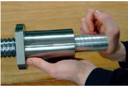
Fig. 10.5 Montaggio della chiocciola con tenuta NBR/TPU sull'albero
