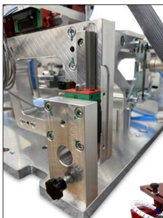
Dettaglio modulo della Sip Italy CP341-FG-SIP, dove trovano applicazione alcune guide lineari a sfere serie HG, Sip Italy.
