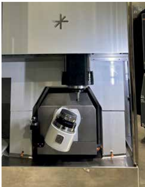
Il vantaggio della trasmissione diretta sulla RAS 200 sta nell'assenza di gioco
