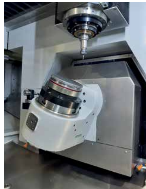
La tavola con motore torque scelta da RCR si è rivelata fondamentale al fine di sfruttare tutte le caratteristiche della tavola stessa
